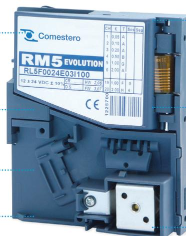
Fino a 59 canali di riconoscimento, tutti reindirizzabili sulle uscite. I primi 6 supportano la modalità Self-Progr
