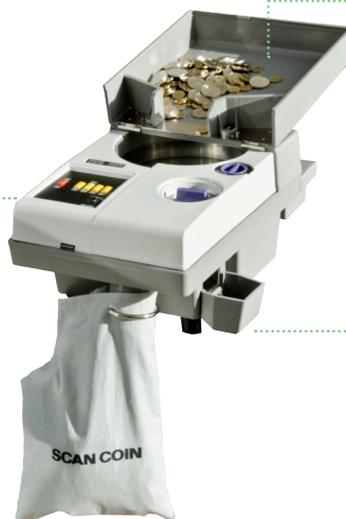
2 diverse regolazioni per diametro e spessore della moneta e di uscita per le monete rifiutate. Possibilità di impostare stop a quantità programmate, stop automatico e rifiuto delle monete danneggiate
